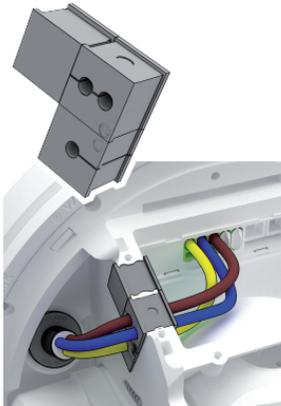
Disposition des joints cubes en Triphasé
