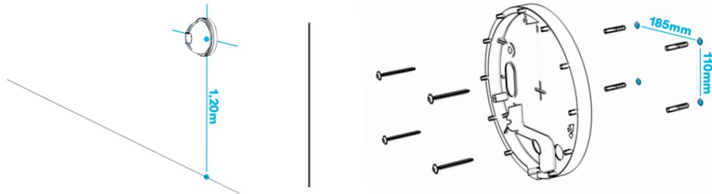
Remarque : Le support mural doit être parfaitement plan et de niveau. Un enduit pourra y être appliqué au préalable. Un mauvais support peut entraîner des déformations excessives de la borne et empêcher son fonctionnement ou dégrader son étanchéité.
